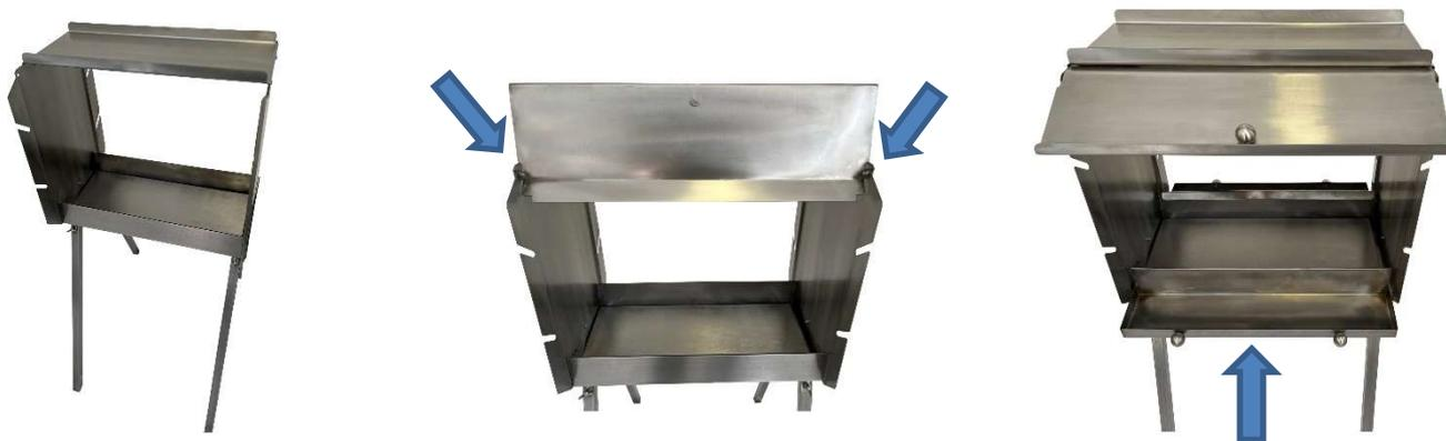
An der Oberkante der Seitenwände, kurz vor der Abschrägung befinden sich an beiden Seiten noch Bohrungen zum Anschrauben der Dachklappe. Bitte Dachklappe anschrauben und den Vorgang auf der gegenüberliegenden Seite wiederholen. Daraufhin können auch schon die beiden Saftschalen einfach an die Glutwanne eingehängt werden.
