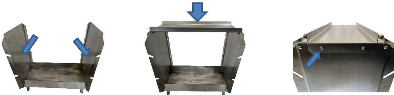
Stellen Sie die Glutwanne auf und stecken die Seitenwände R und L in die vorgesehenen Halteschlitz. Jetzt einfach die Seitenwände jeweils mit einer Linsenkopfschraube und einer Mutter an den der Glutwanne verschrauben. Anschließend das Dachblech auf die Seitenwände setzen und von jeder Seite mit Je 2 Schrauben und Muttern fixieren.
